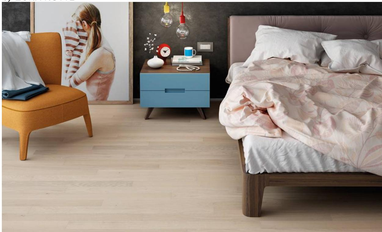
I pavimenti della zona notte saranno realizzati in listoni di legno prefinito, essenza rovere naturale vernice opaca di formato 10x90x900 formati da supporto in multistrato e strato superficiale in legno 4 mm.
